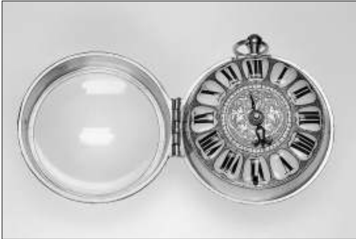
Spindeltaschenuhr, hohes Spindelwerk mit Darmsaite und Schnecke, sign. Hubert Dastry, Toulouse, um 1700, sog. „Oignon“, ein Zeiger
